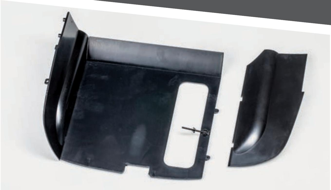
Аналогичным образом установите и закрепите двумя винтами 1,7×4 (AP) правую обивку на полу багажника. Винт крепления запасного колеса, установленный ранее, направлен внутрь багажника и не должен мешать монтажу обивки. На данном этапе сборки во избежание поломки деталей не прилагайте излишних усилий к обивкам багажника. В дальнейшем они получат дополнительные точки фиксации на передней обивке багажника.
