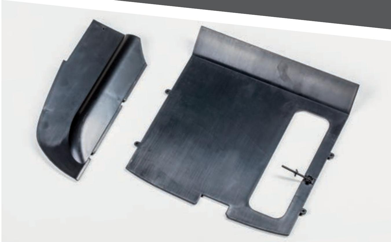
Установите левую обивку поверх пола багажника. Совместите крепежные отверстия обивки, расположенные на нижней грани, с ответными отверстиями крепежных проушин в левой части пола багажника. Закрепите обивку с нижней стороны пола багажника двумя винтами 1,7×4 (AP).
